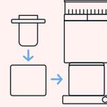
Manyetik olarak ayarlanan hazneye portafiltre doz bardağını yerleştirin ve boşaltma oluşunun altına kaydırın.
