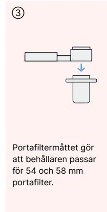
Portafiltermättet gör att behållaren passar för 54 och 58 mm portafilter.
