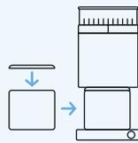
Setzen Sie den Verschlussdeckel auf den Auffangbehälter und schieben Sie ihn unter den Mahlgutschacht.
