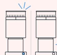
Premere brevemente una volta (o tre) il pulsante di accensione. Rimuovi il raccoglitore quando Opus si ferma automaticamente.
