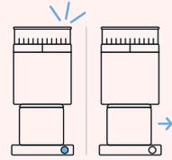
Güç düğmesine kısa süreli (veya üç kez) basın. Opus otomatik olarak durduğunda, hazneyi çıkarın.
