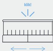
Obracaj pierścieniem, aby wybierać odpowiedni poziom mielenia. Nasłuchuj kliknięcia jako potwierdzenia prawidłowego ustawienia.
