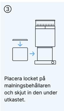
Placera locket på malningsbehållaren och skjut in den under utkastet.
